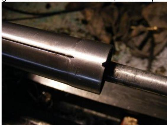
Non ho potuto saldare per tutta la lunghezza perchè lo spazio tra i due lembi è piuttosto alto e il materiale scadente, per cui la saldatura cola anche all'interno e va rettificata anche in quel punto, se lo facessi anche
