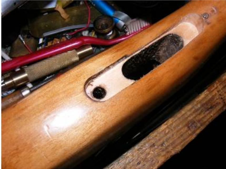
Notate quanto ora il punto di fissaggio sia più in basso e più indietro del foro originale e l'imperfezione nel primo tratto di fresatura fatta dall'operaio della Norconia che sbagliò in fabbrica infatti si nota ancora la vernice originale, per risolvere penso stuccherò anche se il punto non è per niente visibile e forse si potrebbe lasciare così, vedrò poi con il ponticello definitivo. Il foro originale addirittura non era neppure in asse con la canna, ora per fortuna è tutto regolare.
