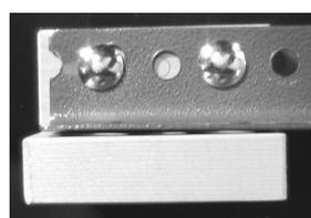
Il perno fisso, ricavato dalla barra filettata del 10 andrà fissato centralmente nel nostro primo pezzo, fresando la parte inferiore in modo di "incassare" il bullone di tenuta così che non sporga sotto, compromettendo il "piano" della macchinetta.
